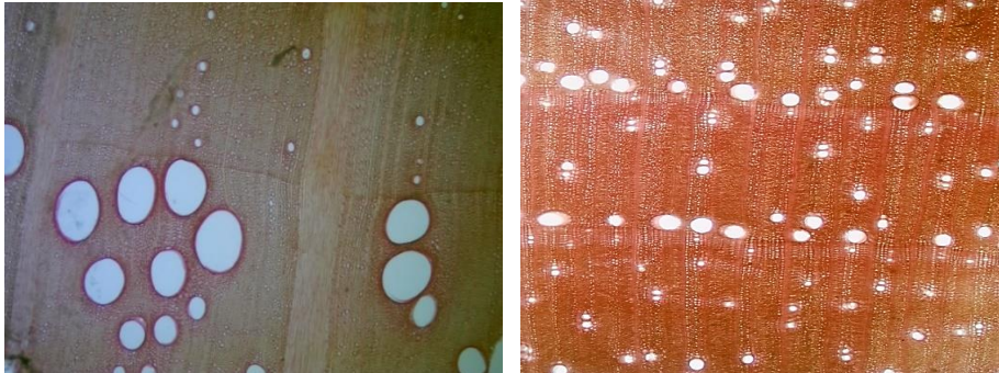
Фигура 7. Напречен разрез на дървесина от: а) акация; б) ясен.
