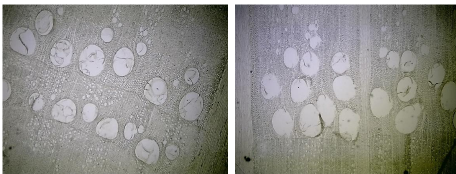
Фигура 6. Напречен разрез на дървесина от: а) летен дъб; б) зимен дъб.
