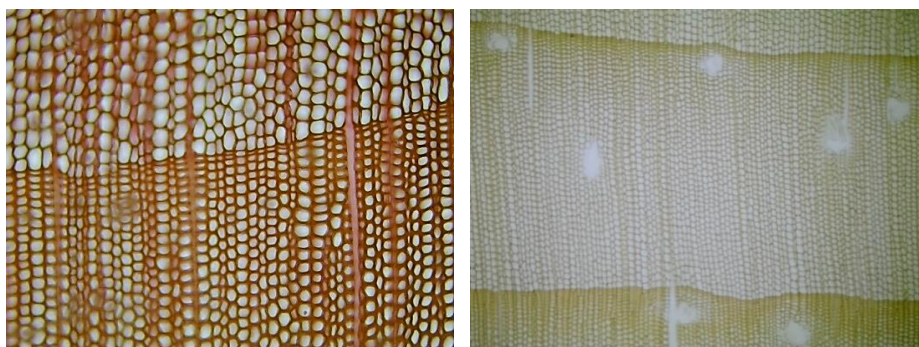
Фигура 3. Напречен разрез на дървесина от: а) бор; б) смърч
