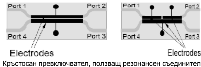
Кръстосан превключвател, ползващ резонансен съединител.
