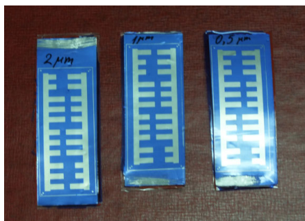
Фигура 3. Образци на заготовки с оксид с различна дебелина
