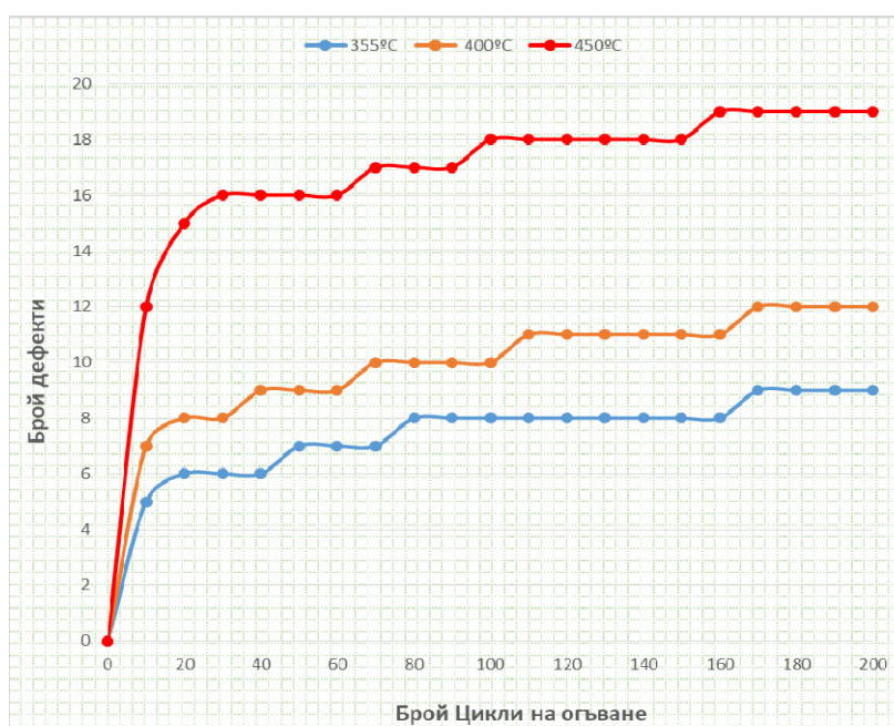
Фигура 40. Изменение на броя дефекти от броя термични цикли за 20 \mu\text{m} ААО върху алуминиева основа
