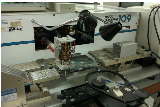
Фигура 36. Pick&Place машина за поставяне на SMD компоненти
